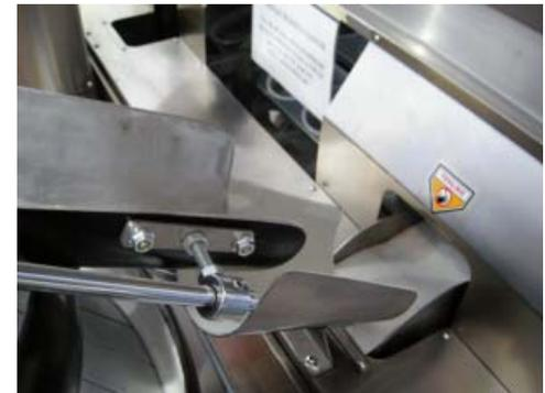
La Chambre de repos ( Balancelle ) est communément employée dans les lignes automatiques de panification. Les pâtons provenant de la diviseuse / bouleuse, avant façonnage et fermentation finale, y sont soumis à la pré - fermentation.
